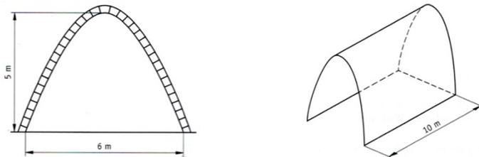
Abbildung 1: Angaben zu den Abmessungen des Tunnels
